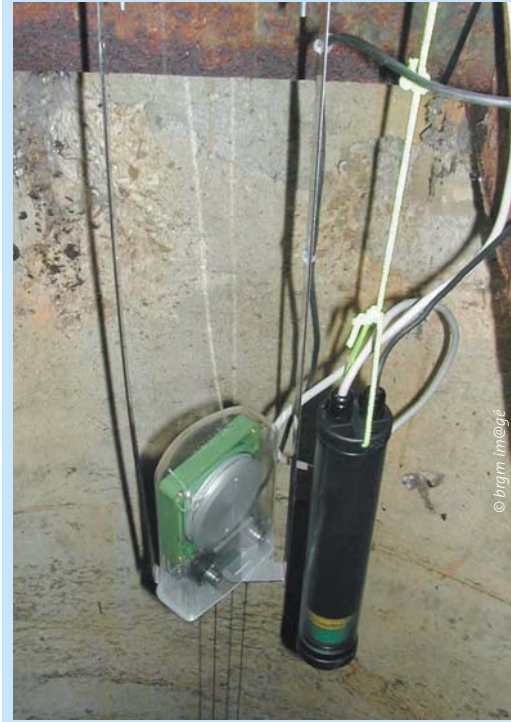
Piezomètre : Instrument de mesure des nappes d'eau souterraine
