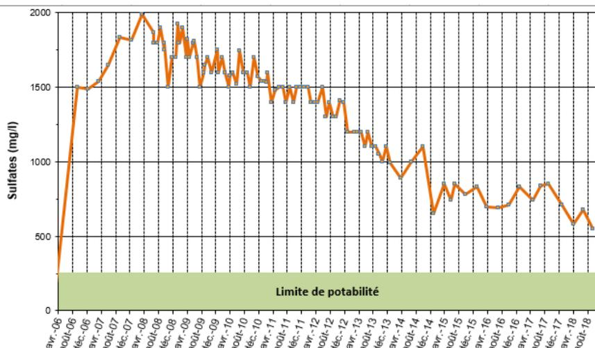
Après une forte baisse de la concentration en sulfate mesurée au point de débordement du réservoir Nord (galerie de la Paix—N14bis) depuis l’ennoyage jusqu’en 2014 (-62%), la concentration en sulfate poursuit sa baisse mais de façon moins rapide.
